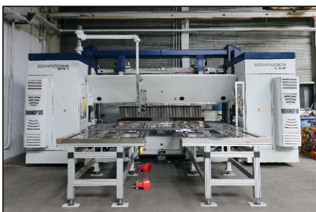
Schwenkbiegemaschine 4.040 mm x 4 mm
