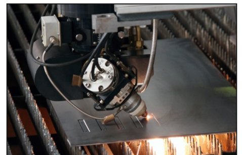
Fasen-Laserschneiden bis 45° / 16 m
