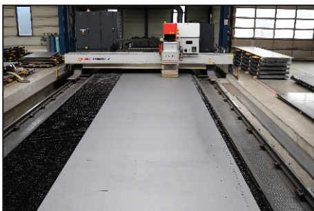
Laserschneidanlage 16.000 x 4.000 mm
